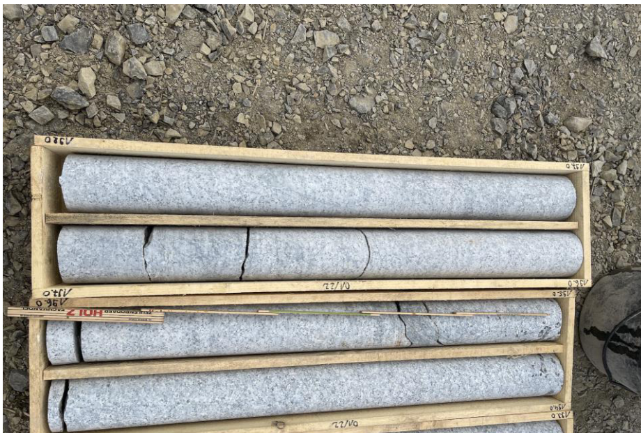
Bohrkerne der Bohrung aus der Tiefe von 194–198 Metern (DESY, Katharina Henjes-Kunst)
